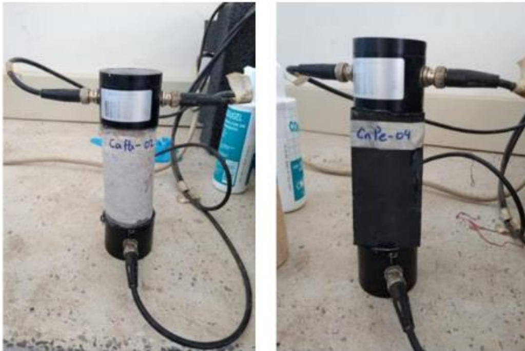
Figura 31. Determinación de velocidad de onda de pulso ultrasónico
