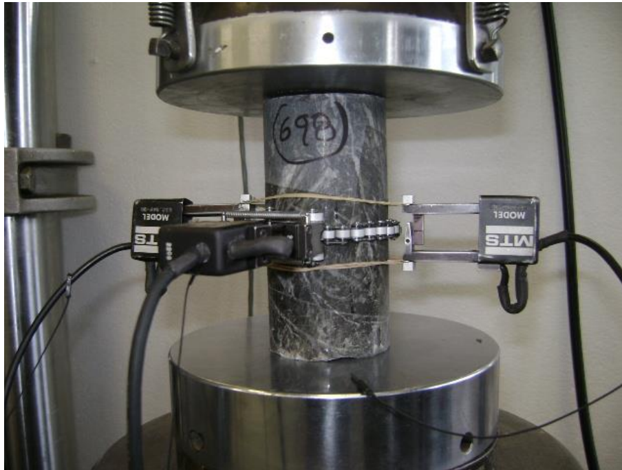
Figura 26. Ensayo a compresión simple en rocas.
