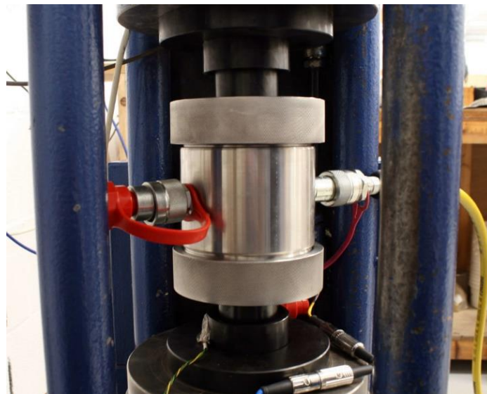
Figura 28. Montaje para el ensayo triaxial en roca
