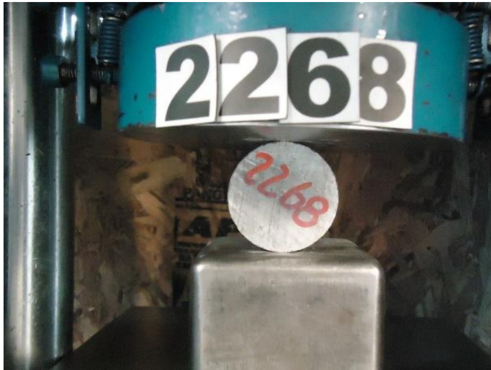
Figura 27. Montaje para el ensayo de tracción brasileño
