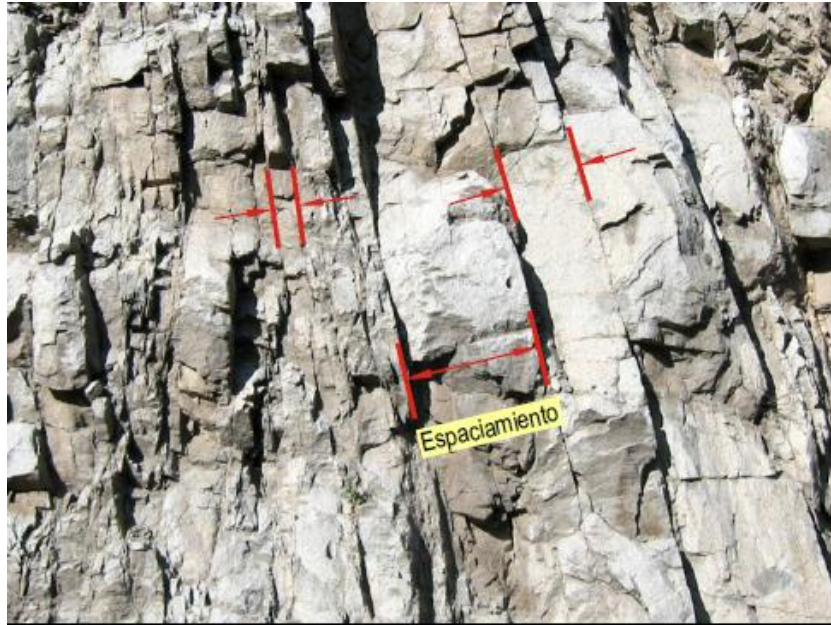
Figura 39. Espaciamiento de las discontinuidades en un frente de macizo rocoso
