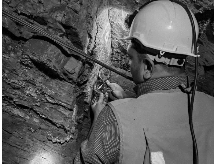
Figura 37. Mapeo de orientación de discontinuidades con brújula
