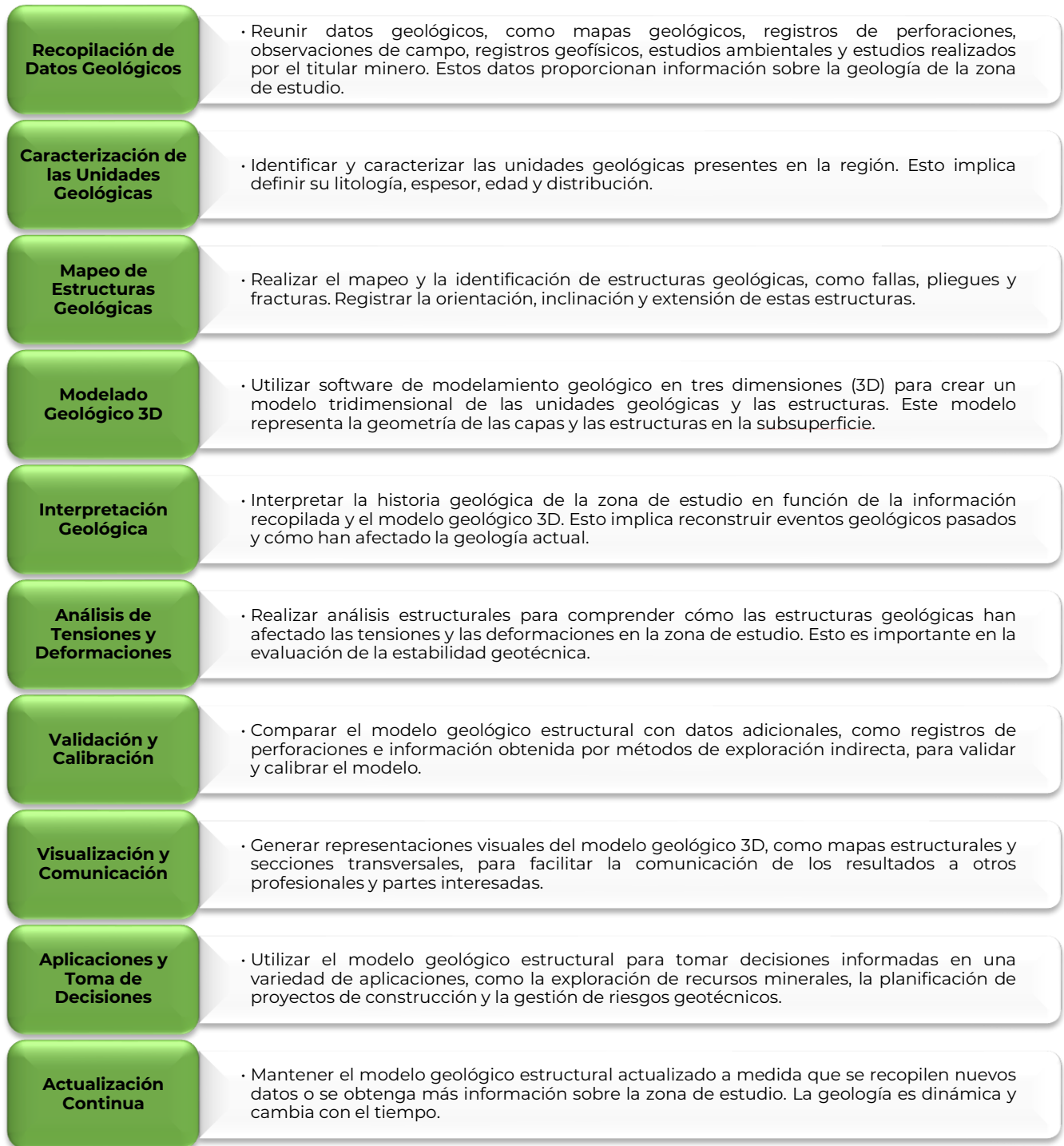
Figura 22. Pasos para realizar el modelamiento estructural
