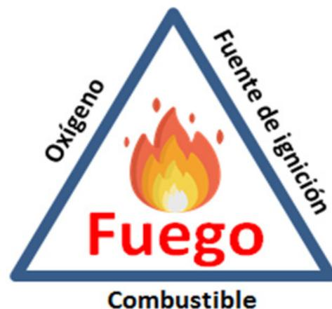
**Figura A1.** Triángulo del fuego.
