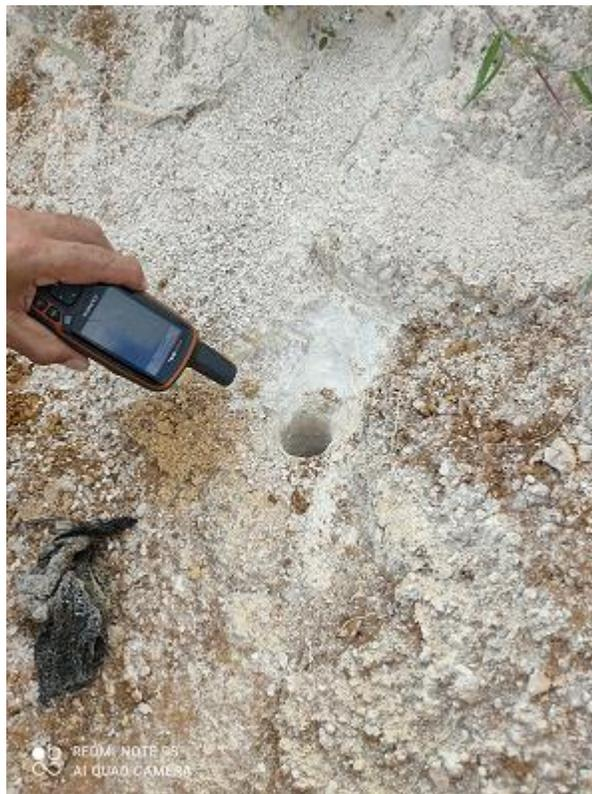
Punto 1. Evidencia de perforación para voladura con explosivos artesanales
