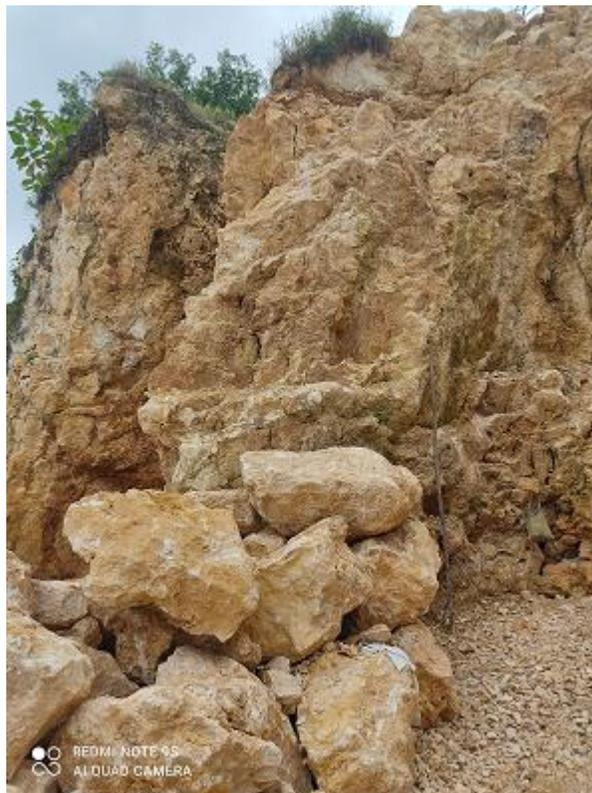
Punto 10. Bloques acopiados luego de la voladura realizada para el desprendimiento del material.
