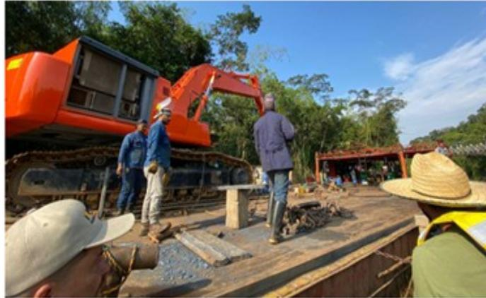
Fotografía 5. Retroexcavadora Hitachi Zaxis 650H
