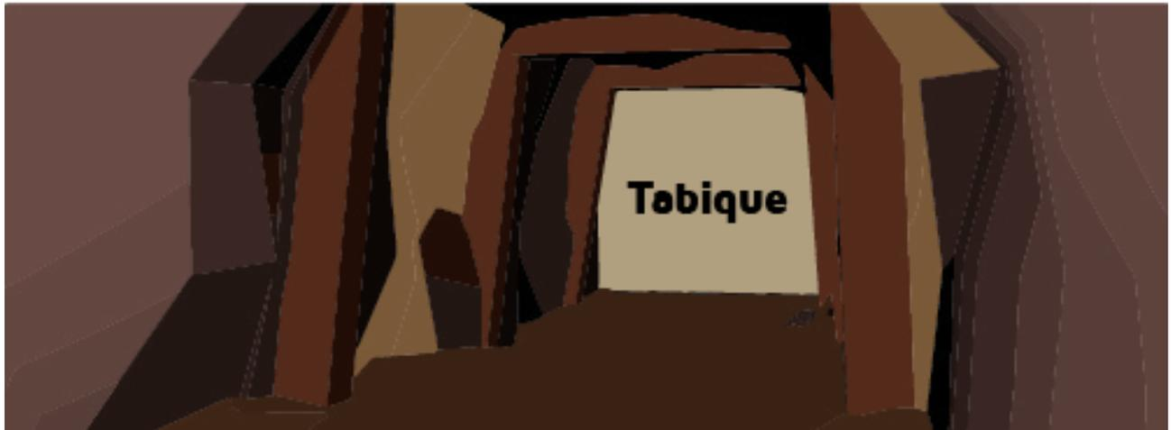
Construyendo un tabique en tela de ventilación impregnado, encauchetados o con plástico, fijándolo al sostenimiento de la vía o fabricando un marco especial.
