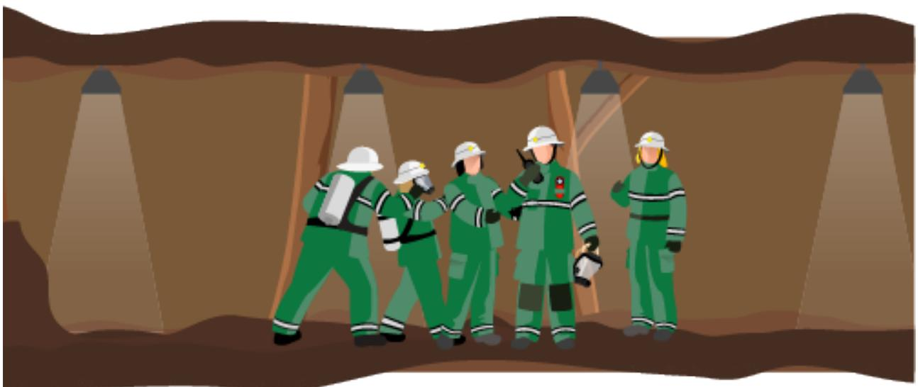
Haga lectura de manómetros en cada uno de los equipos de circuito cerrado de respiración de los socorredores y anote los resultados en la tarjeta de control de oxígeno.
