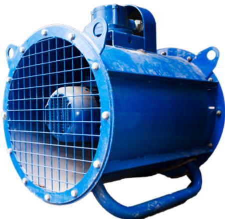
El ventilador debe emplazarse con el eje del rotor en posición horizontal. El protector del ventilador a la entrada debe instalarse en todo momento durante la operación. El ventilador debe funcionar en un rango de temperatura de  $-200^{\circ}\text{C}$  a  $+40^{\circ}\text{C}$ .
