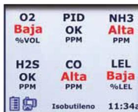
Las alarmas se muestran con el texto "Go/No Go" (Si/No) y la retroiluminación titila.
