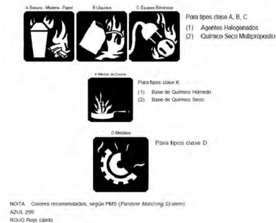
Extinguidores de fuego portátiles Fuente: Icontec; Norma Técnica Colombiana 2885
