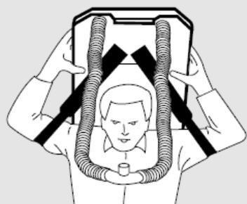
Levante el PSS BG 4 encima de la cabeza, manteniendo su cabeza entre las mangueras de respiración y permita que el PSS BG 4 se deslice por su espalda, hasta que las correas de los hombros descansen sobre sus hombros.
