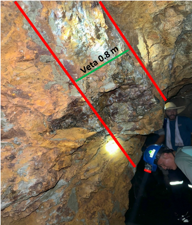
Registro fotográfico No 3. Veta principal N45E de 0.8m del túnel La Capilla.
