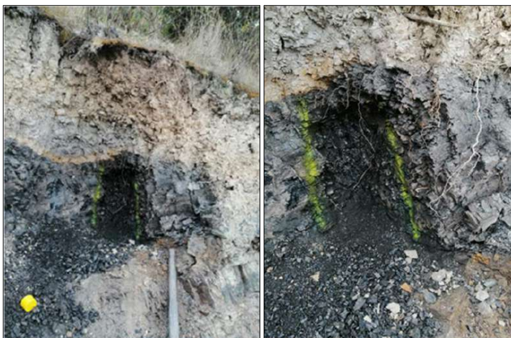
Fotografía 1. Muestreo de canal en carbones.
